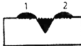
Figura 21: Secção do sulco mostrando a existência de uma área de corte e de uma área de deformação 5 .
